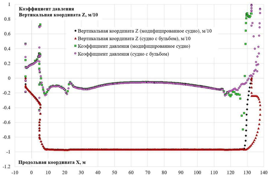
Рис. 10 Распределение коэффициента давления по обводу погруженной в воду части корпусов в плоскости симметрии ( $V=15$  узлов)
