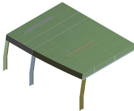
Рис. 2 Пример модели для частичного анализа — платформа под грузовую лебедку
